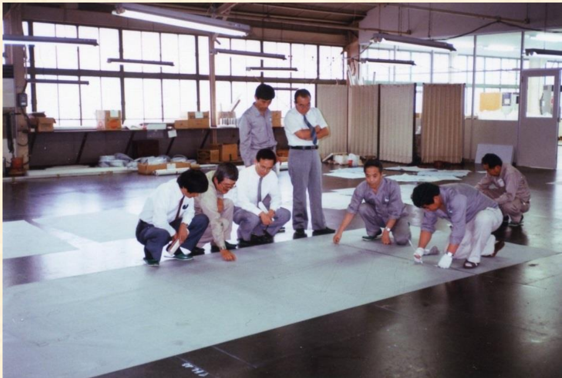
1991年 取手工場 現寸場 (横浜ランドマークタワーの現寸検査中)
