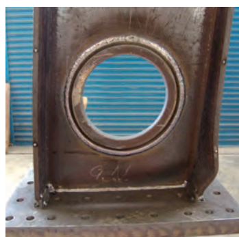
EGリング補強貫通孔
