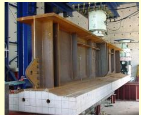
桁の負曲げ試験状況
