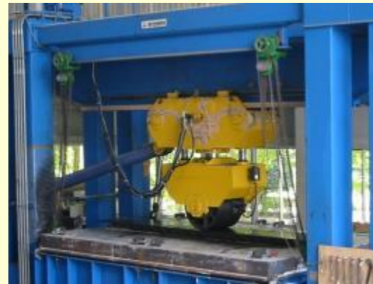
輪荷重走行試験状況
