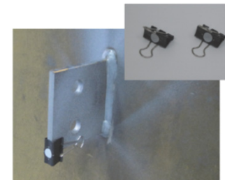
クリップ式ターゲット （取り付けが容易）
