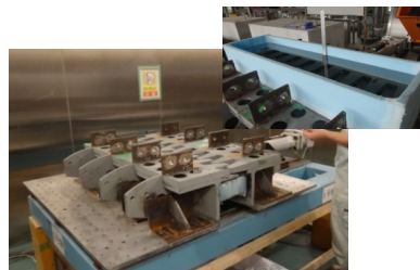
図-6 止水性能確認試験状況
